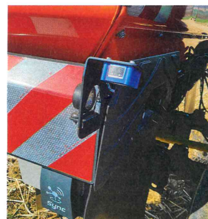
Ein Radarsensor an jeder Ecke des Düngerstreuers ermittelt konstant den jeweiligen Abstand zum Boden. Foto: Huehne
