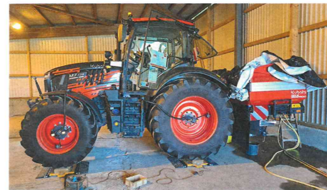
Das Versuchsspann stand auf vier Wiegezellen. Foto: Lüdemann
