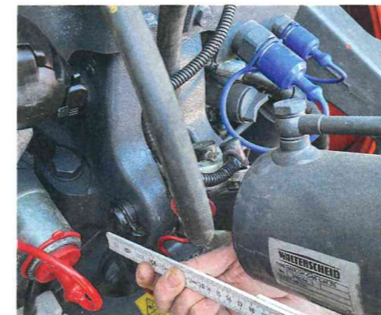
Der Lagesensor sitzt unten am Oberlenker. Foto: Huehne
