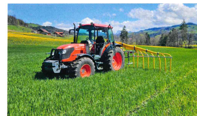
Le Kubota «M 9540» sert ici à l'épandage de lisier au moyen d'une rampe à pendillards portée.
